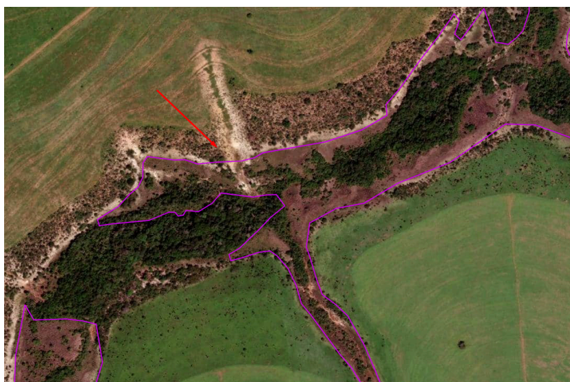
Figura 39 - Exemplo de mapeamento correto, pois identifica o limite original da vereda antes do processo erosivo carrear sedimentos para o interior da vereda.
